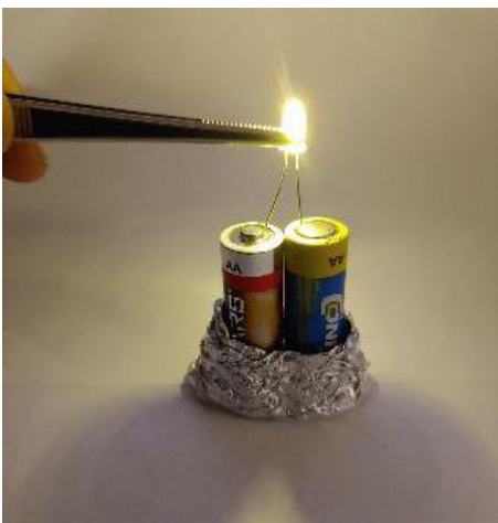
Abbildung: Experimenteller Aufbau und Schaltplan zum einfachen Stromkreis einer Leuchtdiode.
